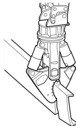
**Резка широкой профилированной строительной стали**
