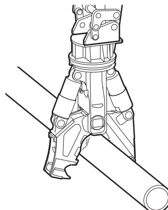
**Резка профилированной строительной стали, труб**
