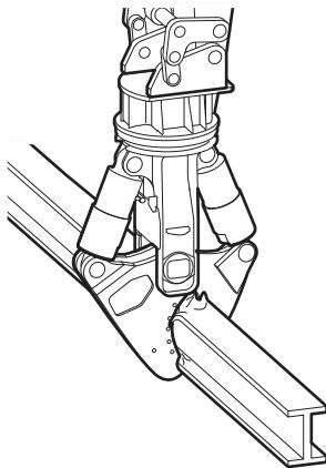
Кончик режущего захвата прорежет стенку балки.
